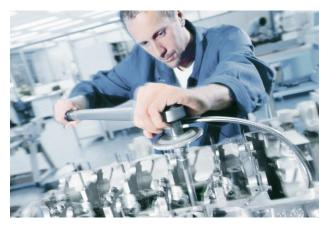
Em adicional, novos parafusos de cabeçote necessitam da instalação usando os procedimentos de aperto (torque) e sequências desenvolvidas para os motores pelos fabricantes. O processo de aperto utilizando torque a ângulo de rotação resulta em uma utilização especifica das propriedades dos parafusos. No processo, as minúsculas diferenças do parafuso são alcançadas, isto é, apertando os parafusos além do limite de elasticidade, alcançado assim sua deformação plástica.
