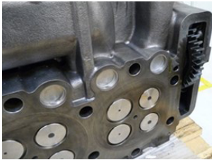
Уплотняемая поверхность ГБЦ с цилиндрическим зубчатым колесом
